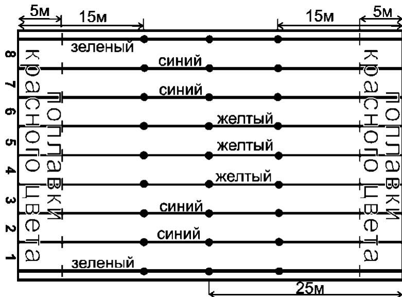
**48.9.** Цвет поплавков у каждого из концов дорожки на длине 5 м от торцевых стенок бассейна должен быть КРАСНЫМ. Между дорожками не
